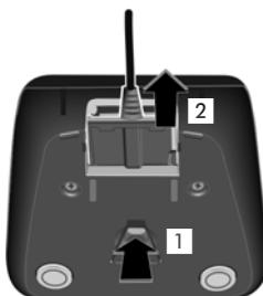
Ukoliko opet morate odvojiti utikač od punjača, pritisnite tipku za deblokiranje **1** i izvucite utikač **2**.
